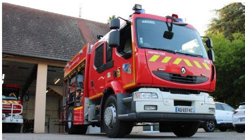
FPTSR: Fourgon Pompe-Tonne/Secours Routier
